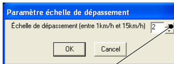
Détermine l'incrément par lequel s'afficheront les messages 1 à 9 au-delà de la vitesse maximum contrôlée par le radar.
