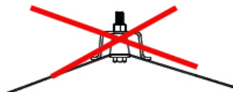
Espaceur pyramidal avec poteau de type U2 de dimensions différentes ou de type U3. Dans ce cas le panneaux fléchit !
